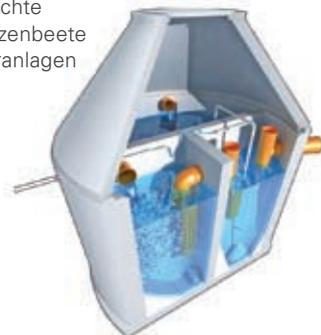
Schema einer Kleinkläranlage mit Abwasserbelüftung
